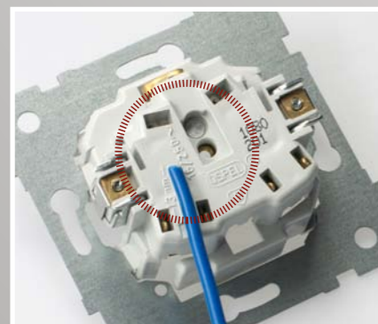
Przymiar umieszczony na tylnej stronie podstawy gniazda ułatwia ustalenie zalecanej długości odizolowania przewodu.
