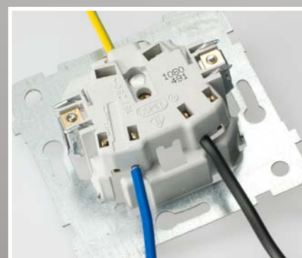
Boczne wyprowadzenie przewodów umożliwia kontrolę jakości ich przyłączenia do zacisku, po ostatecznym zainstalowaniu modułu gniazda w puszcze instalacyjnej.
