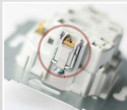
Zabudowa samopowrotnych pazurków rozporowych zabezpiecza palce instalatora przed przypadkowym skaleczeniem.
