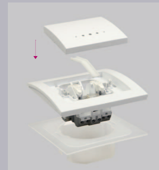
Podwyższenie stopnia ochrony łączników do IP 44, poprzez zamontowanie dodatkowego zestawu uszczelniającego.
